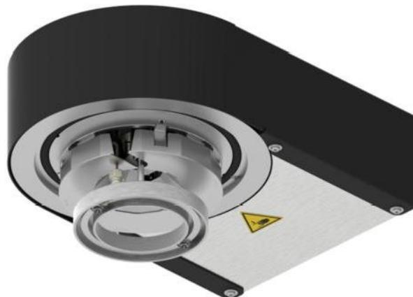
这种集成化设计的插入式碳蒸发模块为碳涂层设定了新的标准。该头插入CCU-010低压和CCU-010高压基本单元，立即准备就绪。应用包括扫描电镜，透射电镜和任何其他需要高质量碳膜的工艺。CT-010采用专利，独特和技术领先的碳纤维缠绕系统。这样就可以在不改变碳源的情况下进行多达50次的涂层。曾经一次 碳纤维部分已蒸发，一个新的部分被自动推进，废纤维落入一个方便的集水盘。除了易于使用外，自动缠绕系统还允许在一个工艺循环中控制沉积任何厚度的碳膜。易于选择的涂层模式可实现安全的涂层，从温敏样品薄膜的温和蒸发到具有 高功率，适用于光纤应用中的厚层。智能功率控制与脉冲蒸发、自动快门后面的脱气和膜厚监测相结合，提供准确的层厚，并避免任何可能导致表面不均匀的起泡现象。
